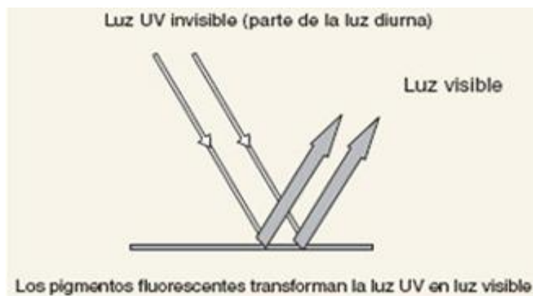
Figura E-2 Material fluorescente de la indumentaria
