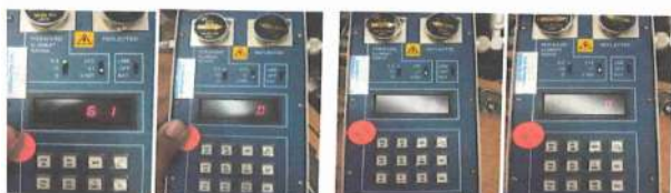
Figura 5. Fx 133.300 MHz (Main/Stdby), potencia y reflejada con carga fantasma.
