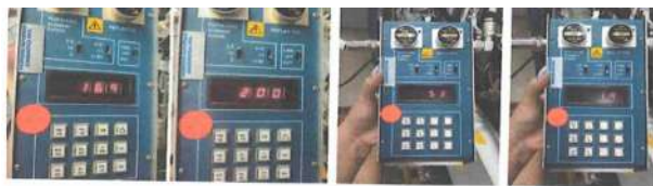
Figura 4. Fx 125.500 MHz (Main/Stdby), potencia y reflejada con antena.
